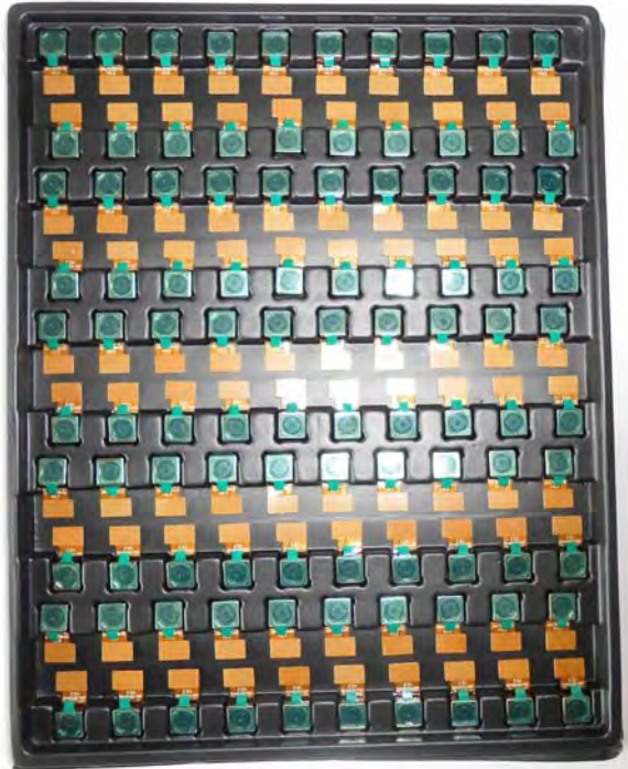
Mettere il vassoio nella borsa antistatica
